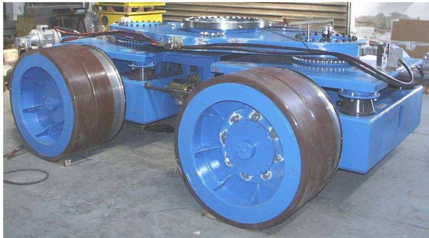
**Figure 24: Wagon porte-conteneurs- Assemblage boggies – Démonstrateur ASAPP ONE©**
